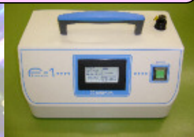
繊維状粒子リアルタイムモニター (Shibata F-1) 除去工事中のモニタリング用
