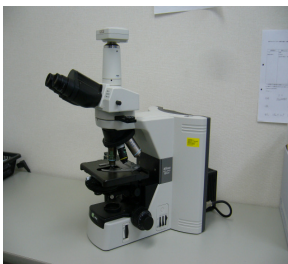
位相差顕微鏡 (Nikon 80i) 建材分析 (分散染色法) 大気繊維計測
