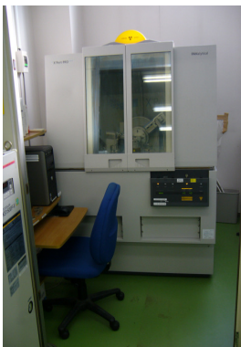
X線回折装置 (PANalytical X'Pert PRO) 建材分析 (元素構造)
